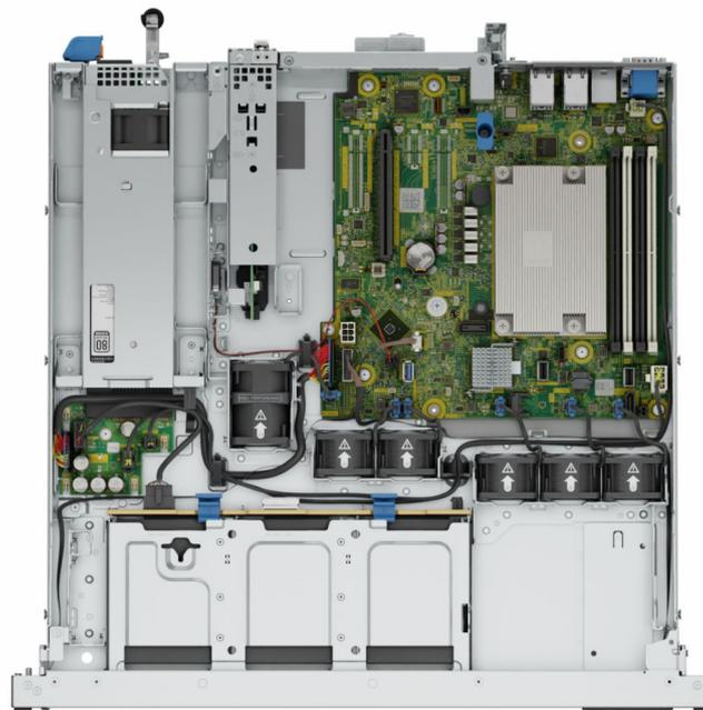
Figure 7. 6 disques SAS/SATA de 2,5 pouces et bloc d'alimentation non câblé sans carte de montage ni carénage
