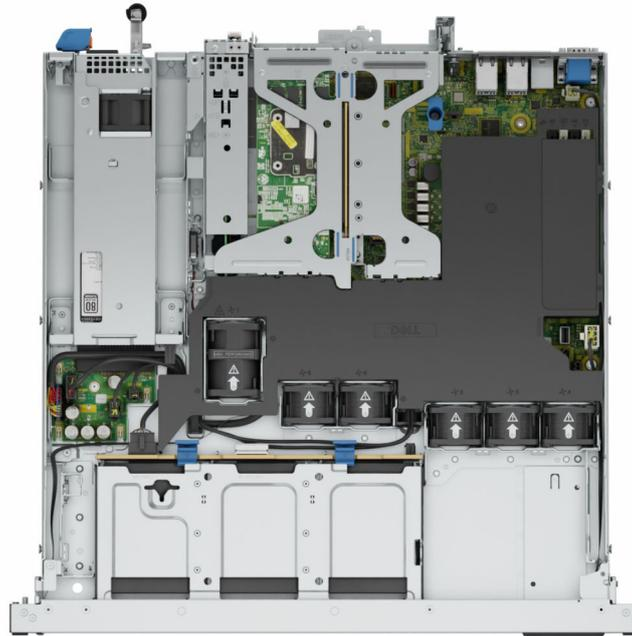
Figure 6. 2 logements PCIe profil bas sur carte de montage avec 6 disques SAS/SATA de 2,5 pouces et bloc d'alimentation non câblé
