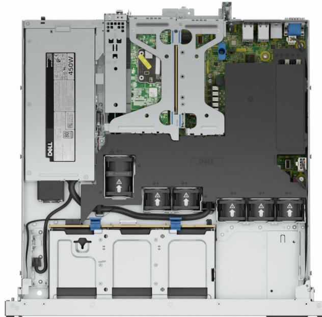
Figure 8. 2 logements PCIe profil bas sur carte de montage avec 6 disques SAS/SATA de 2,5 pouces et bloc d'alimentation câblé
