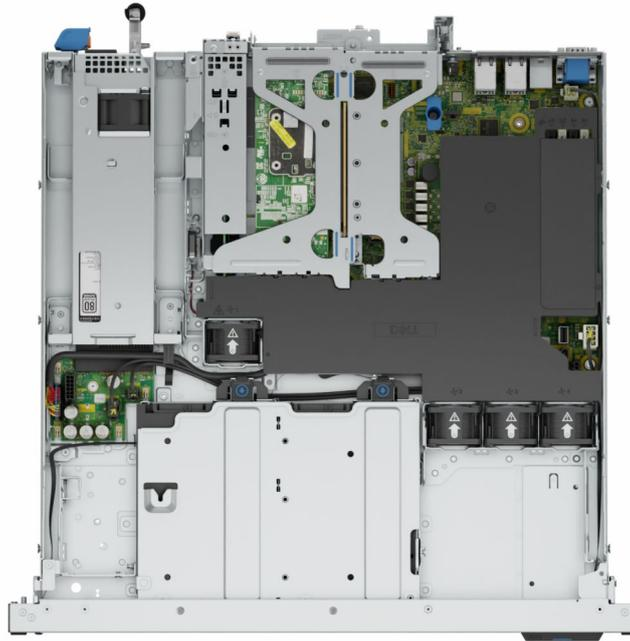
Figure 10. 2 logements PCIe profil bas sur carte de montage avec 2 disques SAS/SATA de 3,5 pouces et bloc d'alimentation non câblé
