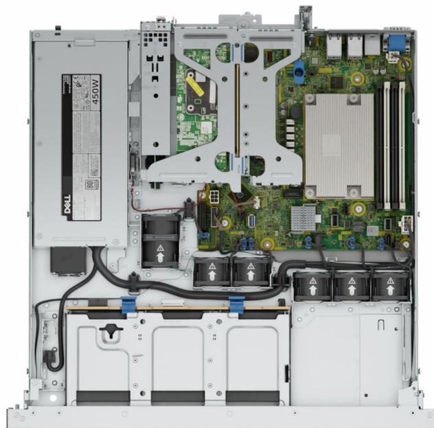
Figure 9. 2 logements PCIe profil bas sur carte de montage avec 6 disques SAS/SATA de 2,5 pouces et bloc d'alimentation câblé sans carénage
