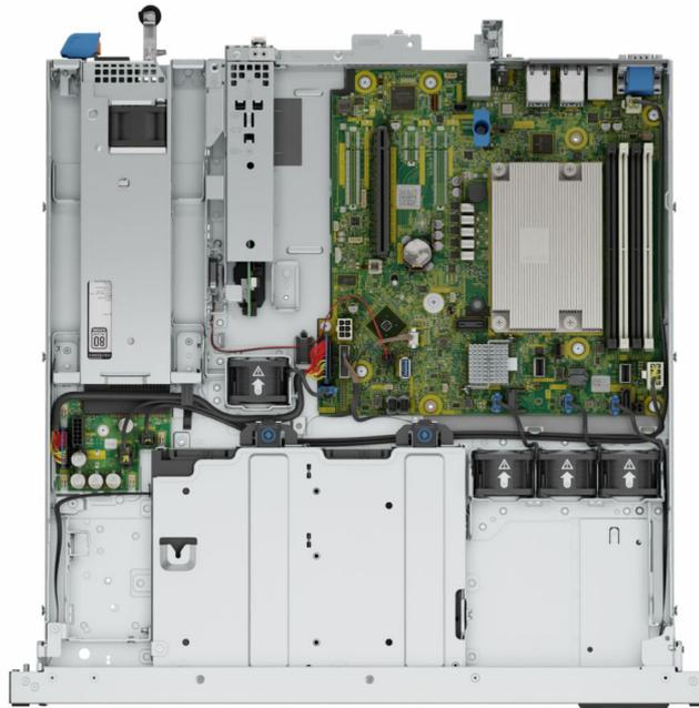
Figure 11. 2 disques SAS/SATA de 3,5 pouces et bloc d'alimentation non câblé sans carénage ni carte de montage
