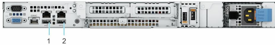
**Figure 18. Ports USB arrière**
