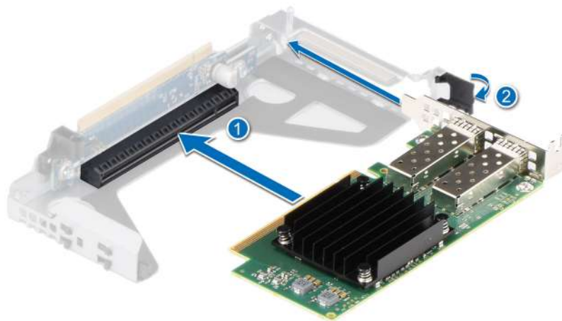
Figure 70. Installation d'une carte d'extension dans la carte de montage 1
