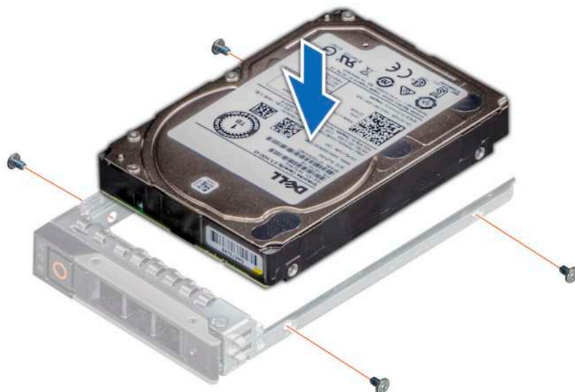
Figure 32. Installation d'un disque dans un support de disque
