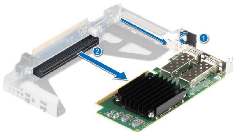
Figure 64. Retrait d'une carte d'extension de la carte de montage 1
