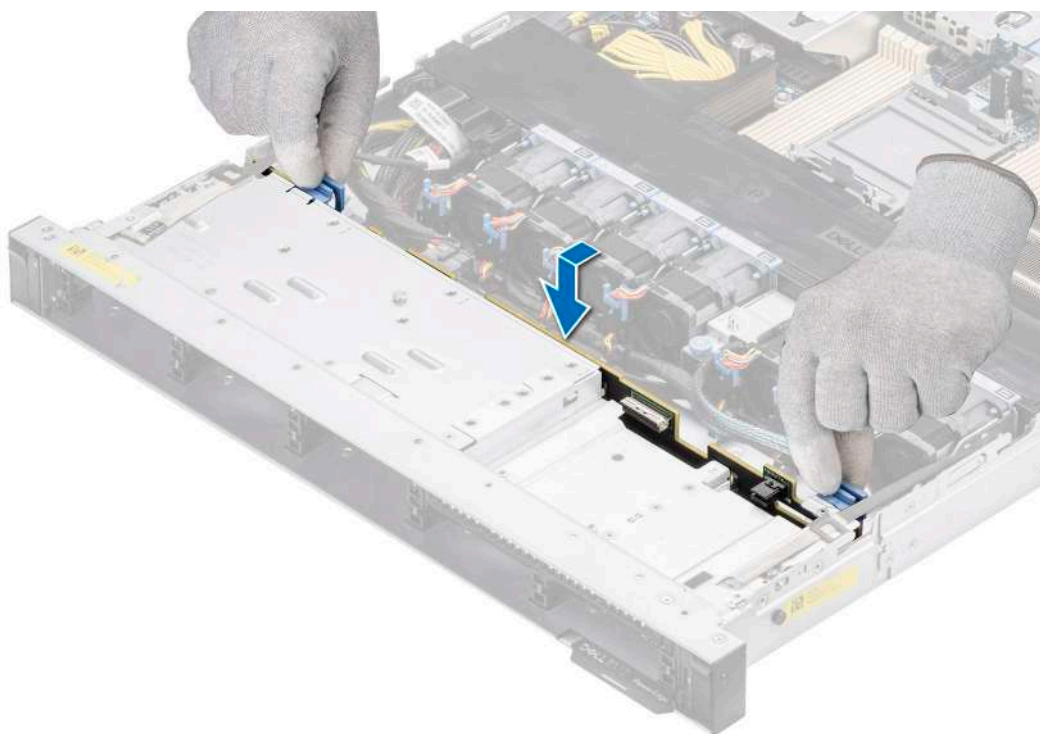
Figure 38. Installation du fond de panier de disque
