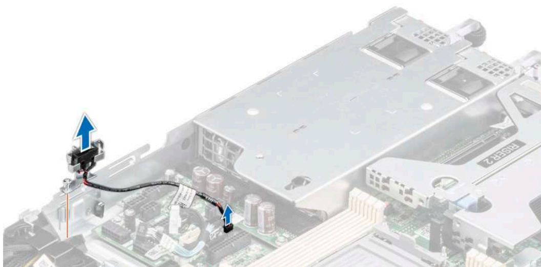
Figure 25. Retrait du module du commutateur d'intrusion
