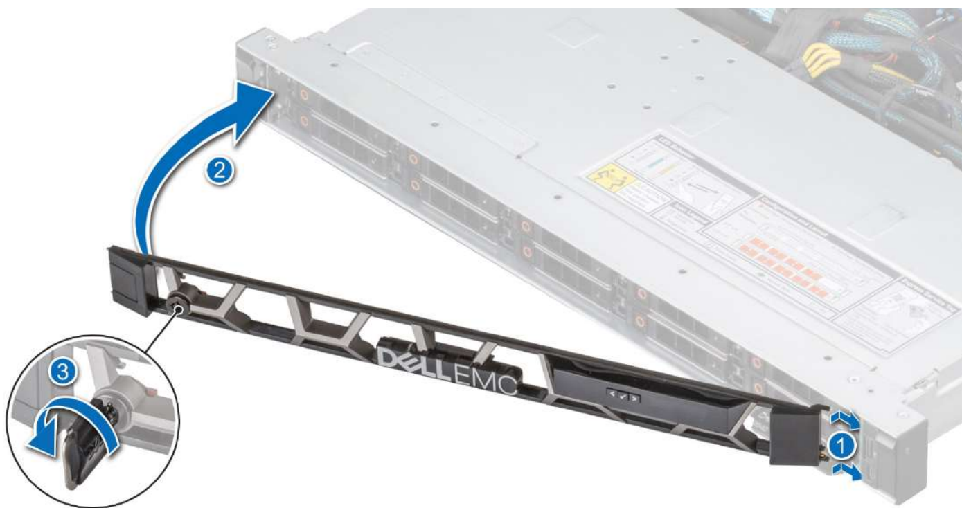
Figure 16. Installation du panneau avant avec l'écran LCD
