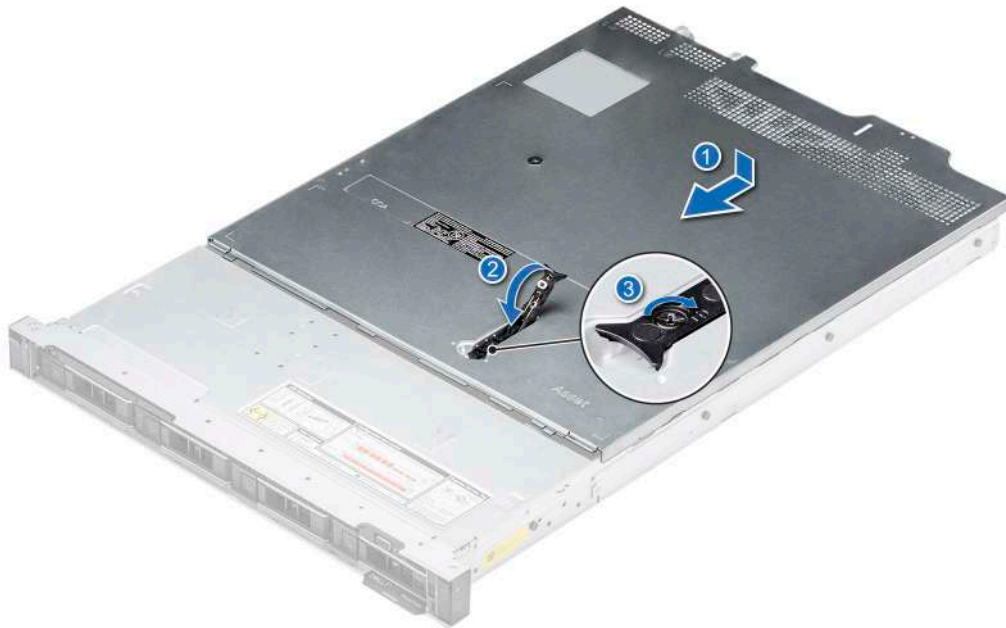
Figure 18. Installation du capot du système
