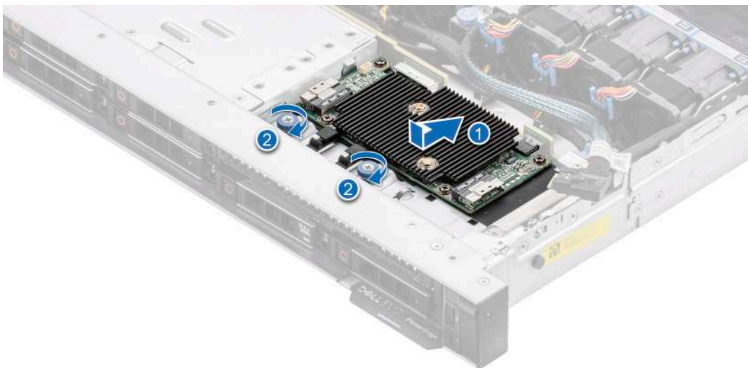
Figure 87. Installation du module PERC avant à montage avant pour un système à 8 disques de 2,5 pouces
