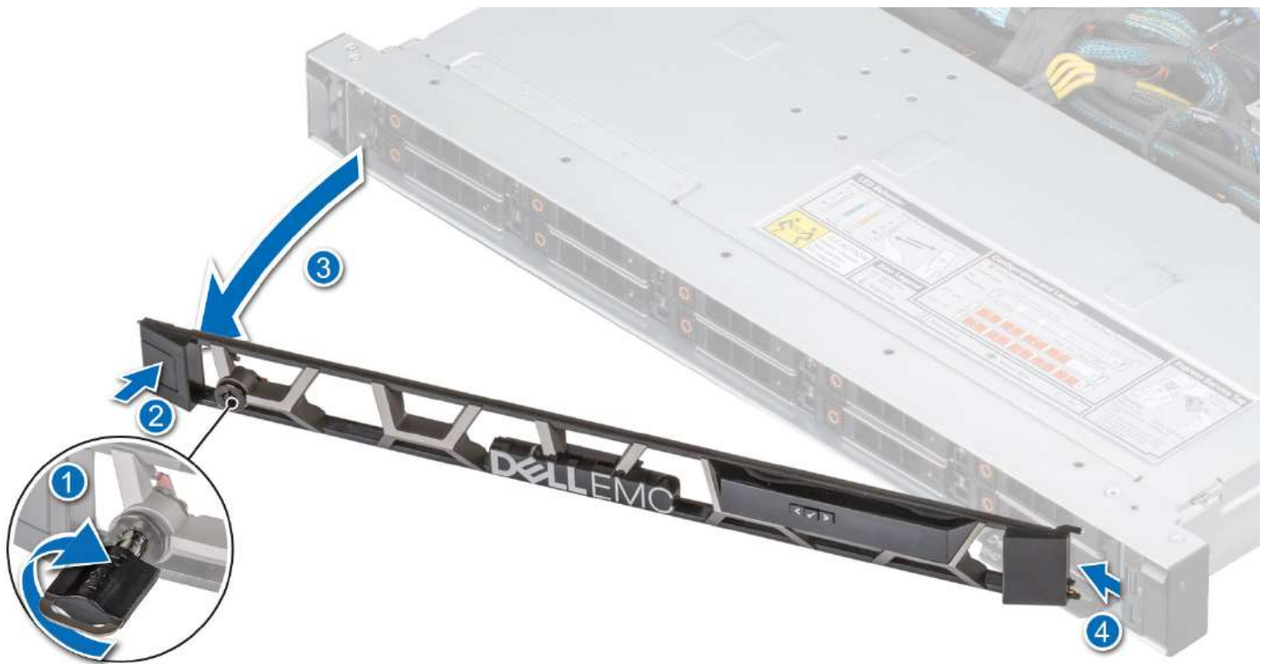
Figure 15. Retrait du panneau avant avec l'écran LCD
