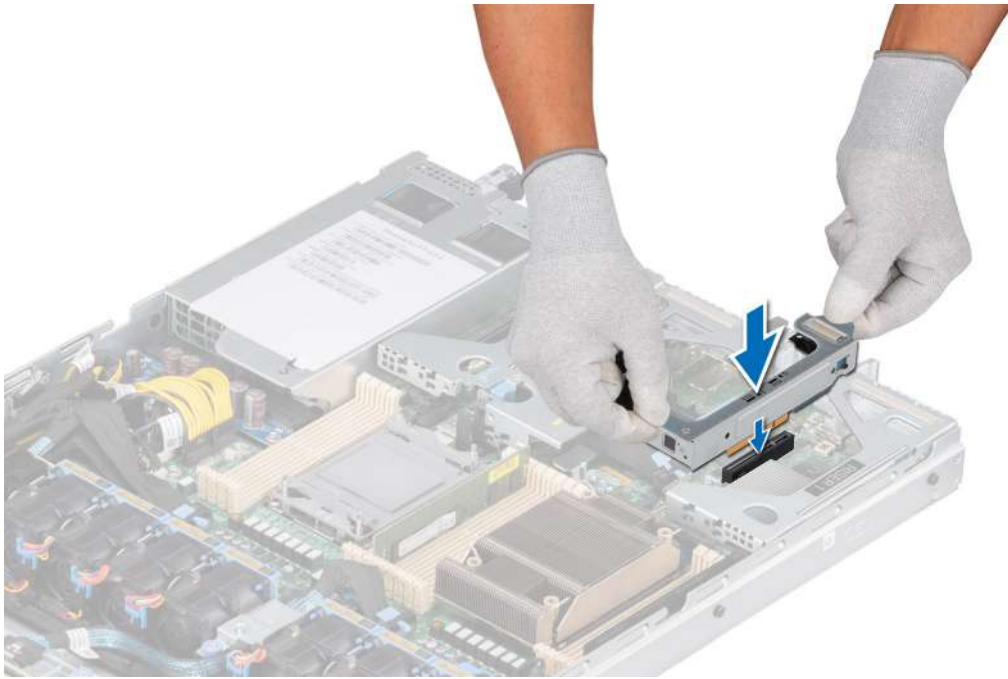
Figure 77. Installation de la carte de montage BOSS M.2
