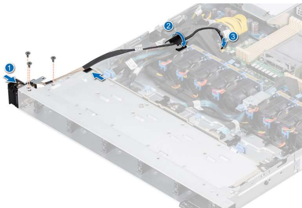
Figure 104. Installation du panneau de configuration gauche
