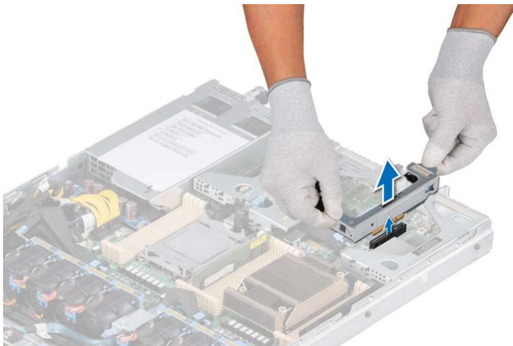
Figure 76. Retrait de la carte de montage BOSS M.2
