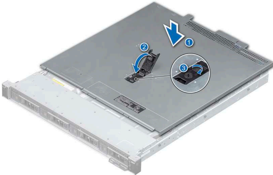
Ilustración 16. Instalación de la cubierta del sistema
