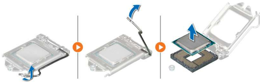
Ilustración 52. Extracción del procesador
