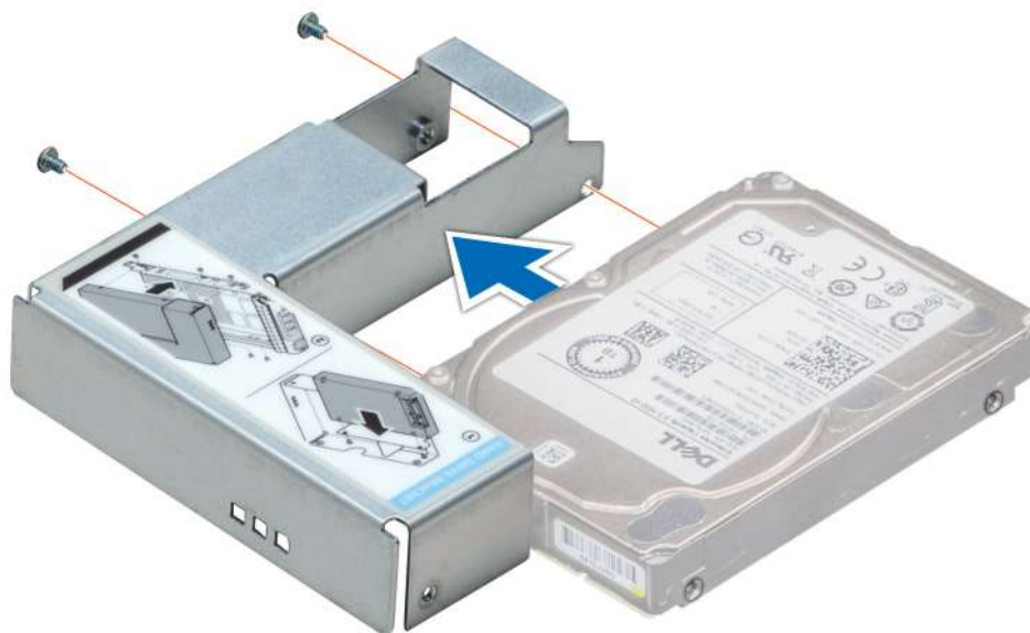
Ilustración 30. Instalación de una unidad de 2,5 pulgadas en el adaptador de unidad de 3,5 pulgadas
