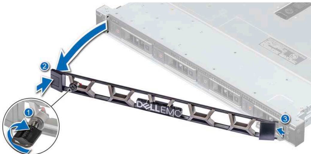
Ilustración 13. Extracción del bisel frontal opcional
