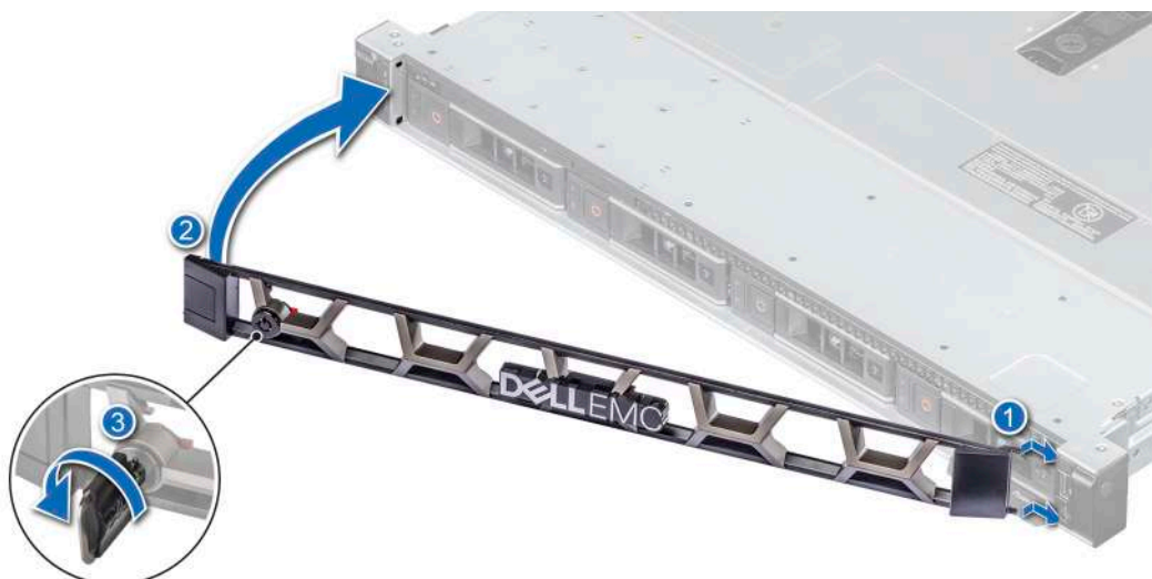
Ilustración 14. Instalación del bisel frontal opcional
