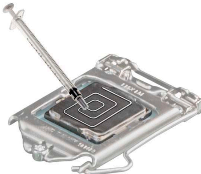
Ilustración 54. Aplicación de la pasta térmica en la parte superior del procesador
