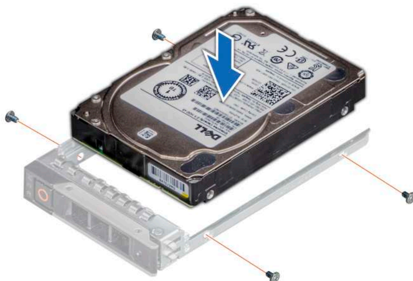
Ilustración 28. Instalación de una unidad en el portaunidades
