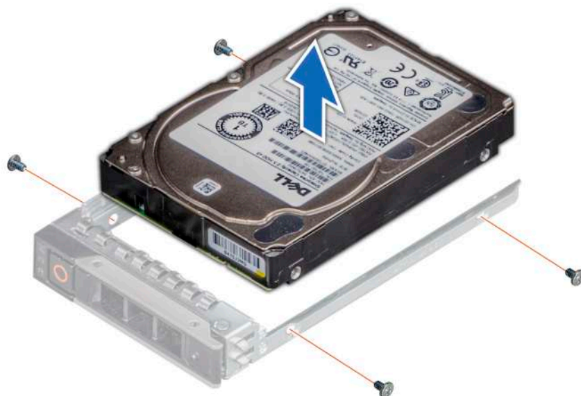
Ilustración 27. Extracción de una unidad del portaunidades
