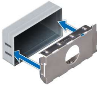
Ilustración 69. Instalación de una unidad de suministro de energía de relleno
