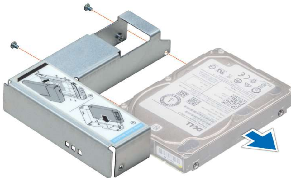
Ilustración 29. Extracción de una unidad de 2,5 pulgadas del adaptador de unidad de 3,5 pulgadas
