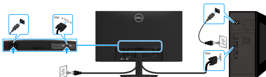
Figur 14. Tilslutning af et VGA-kabel
