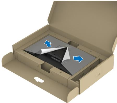
**NOTA:** Antes de fijar el soporte a la pantalla, asegúrese de que la solapa delantera del panel está abierta para dejar espacio para el montaje.
