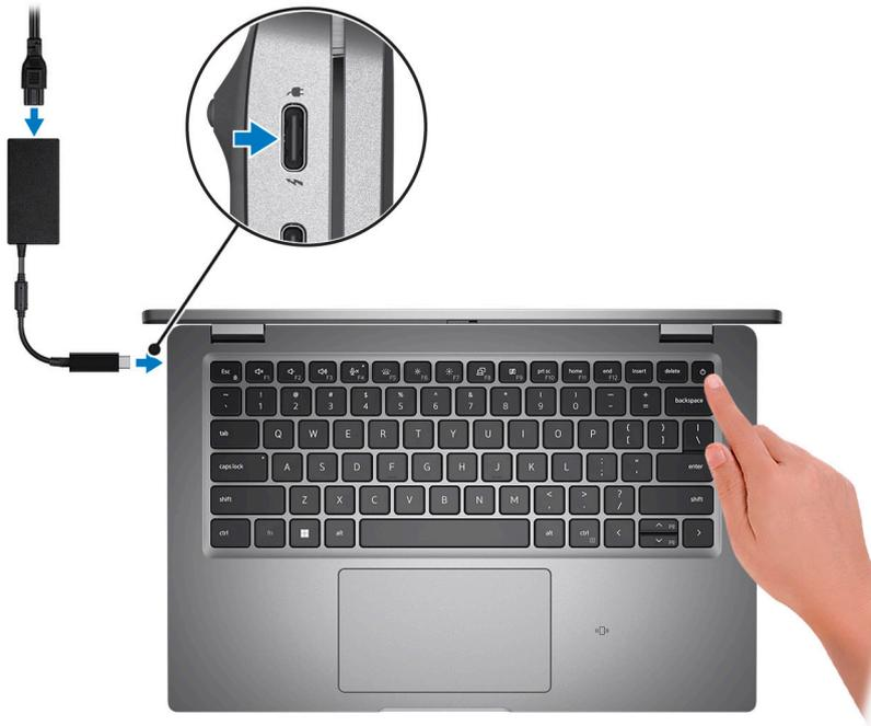
**NOTA:** Para conservar la energía de la batería, es posible que esta ingrese en modo de ahorro energético. Para encender el equipo, conecte el adaptador de alimentación y presione el botón de encendido.
