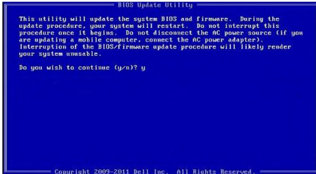
Ilustración 3. Pantalla de actualización del BIOS de DOS
