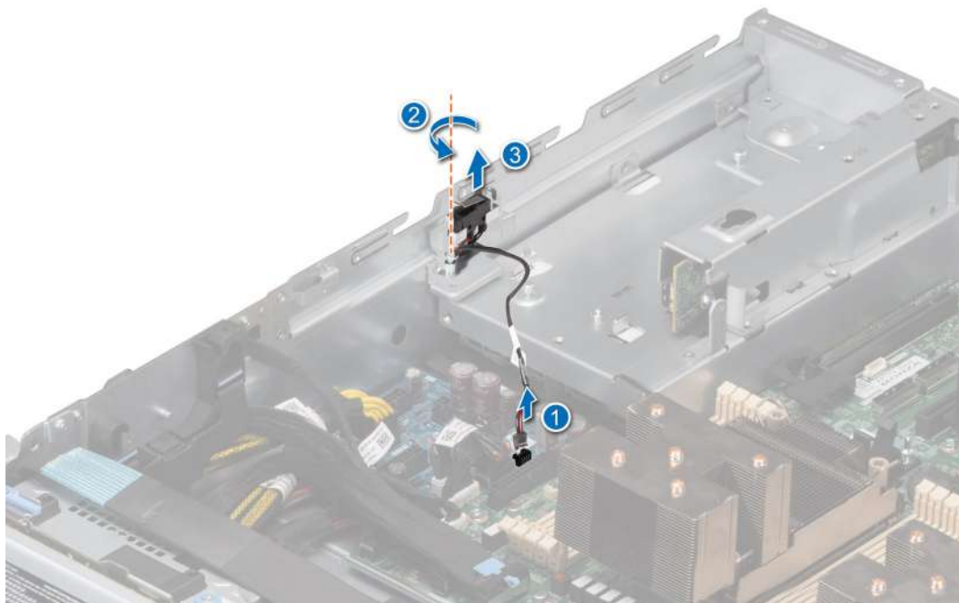
Ilustración 35. Extracción del módulo del interruptor de intrusiones
