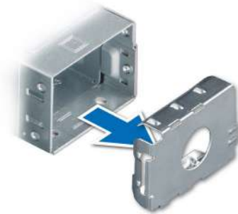
Ilustración 120. Extracción de una fuente de alimentación de relleno
