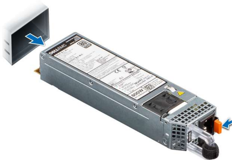
Ilustración 122. Extracción de una unidad de fuente de alimentación
