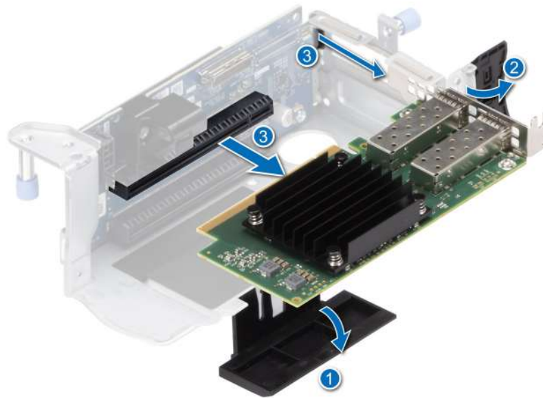
Ilustración 85. Extracción de la tarjeta de expansión del soporte vertical 1B
