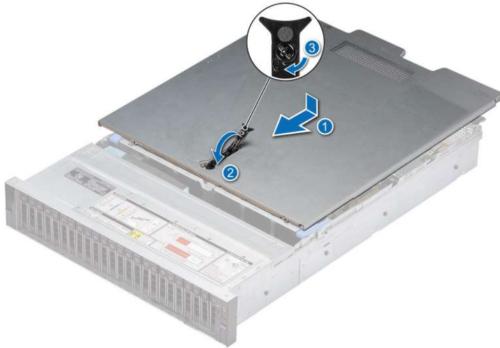
Ilustración 20. Instalación de la cubierta del sistema
