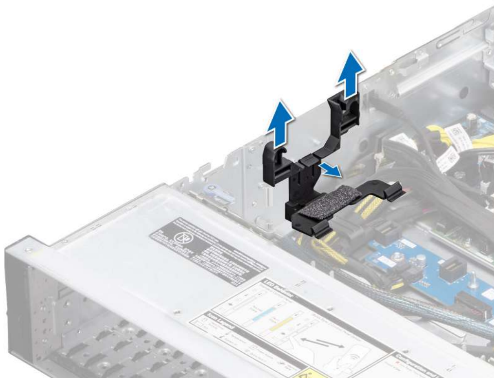
Ilustración 33. Extracción del soporte de pared lateral
