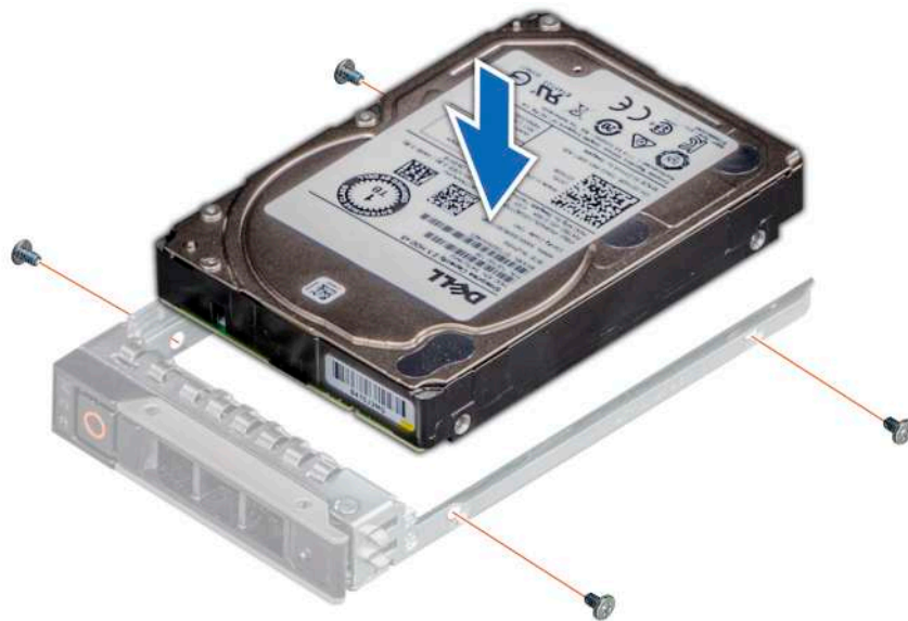
Ilustración 44. Instalación de una unidad en el portaunidades
