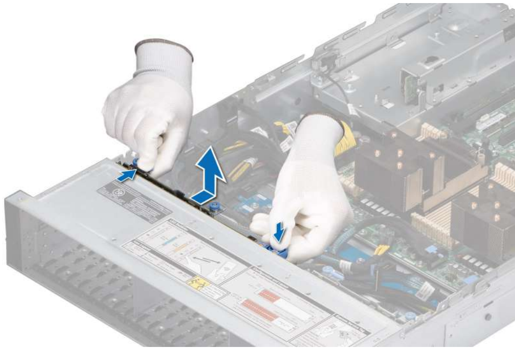
Ilustración 49. Extracción del backplane de la unidad
