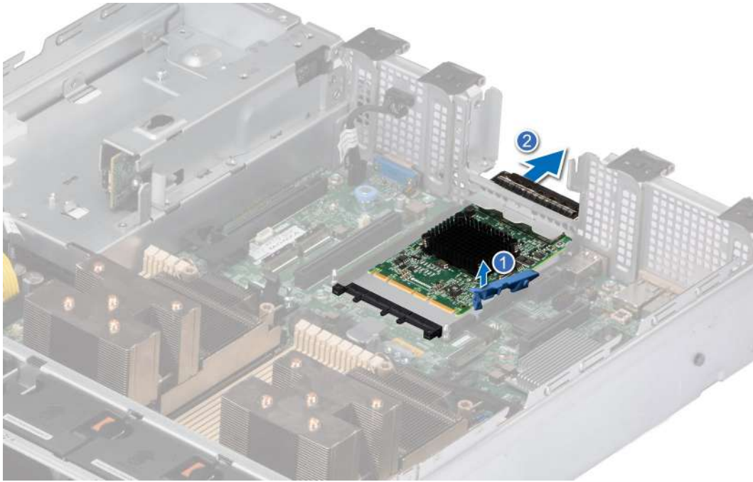
Ilustración 114. Extracción de la tarjeta OCP
