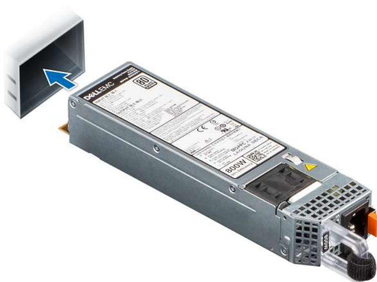
Ilustración 123. Instalación de una fuente de alimentación
