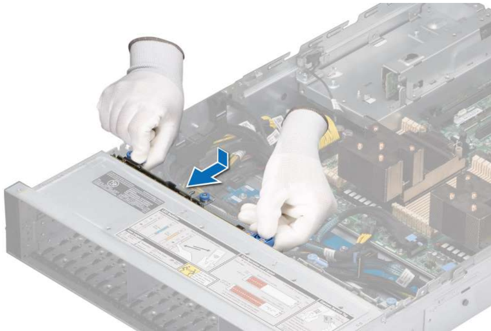
Ilustración 50. Instalación del backplane de la unidad
