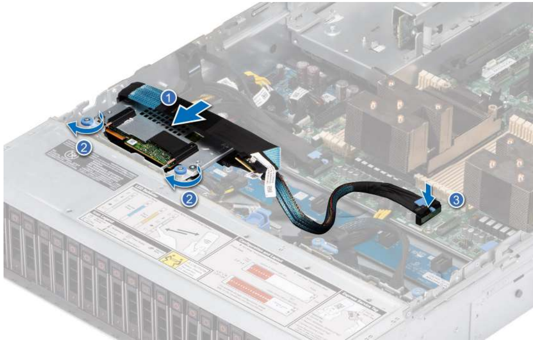
Ilustración 107. Instalación del módulo de PERC frontal de montaje posterior
