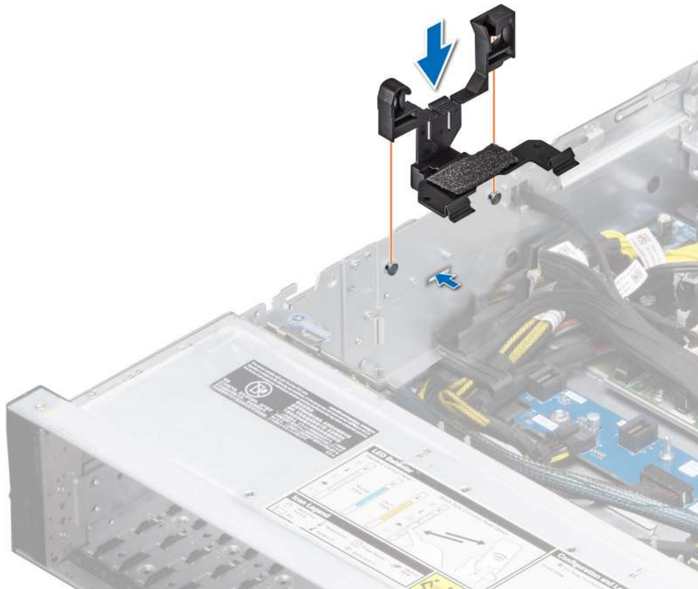
Ilustración 34. Instalación del soporte de pared lateral
