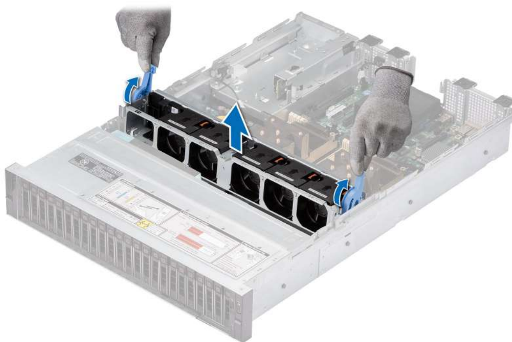
Ilustración 29. Extracción del compartimento del ventilador de refrigeración
