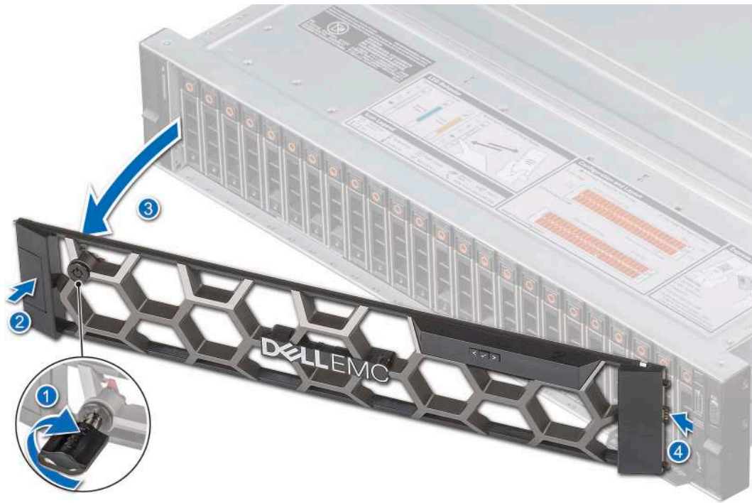
Ilustración 17. Extracción del bisel frontal con el panel LCD
