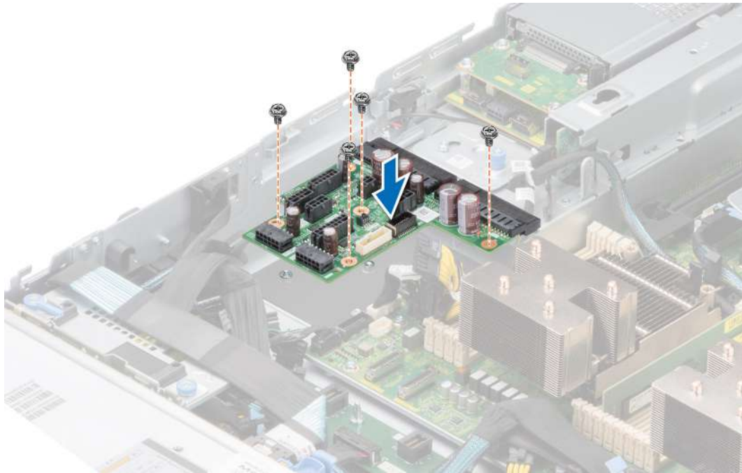
Ilustración 125. Instalación de la placa mediadora de alimentación
