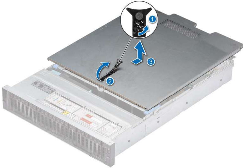
Ilustración 19. Extracción de la cubierta del sistema
