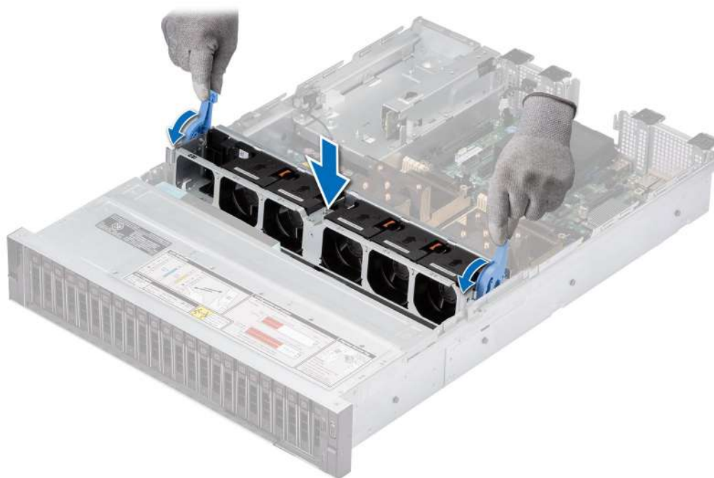
Ilustración 30. Instalación del compartimento del ventilador de refrigeración
