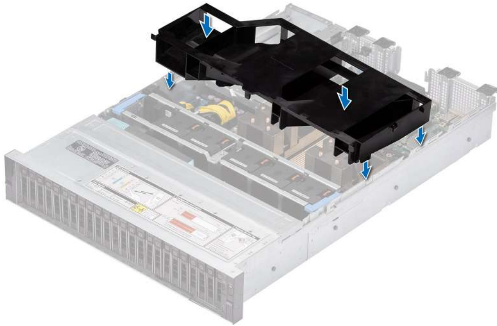
Ilustración 26. Instalación de la cubierta para flujo de aire
