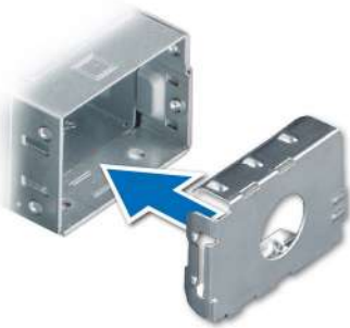
Ilustración 121. Instalación de una fuente de alimentación de relleno
