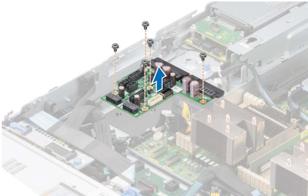
Ilustración 124. Extracción de la placa mediadora de alimentación
