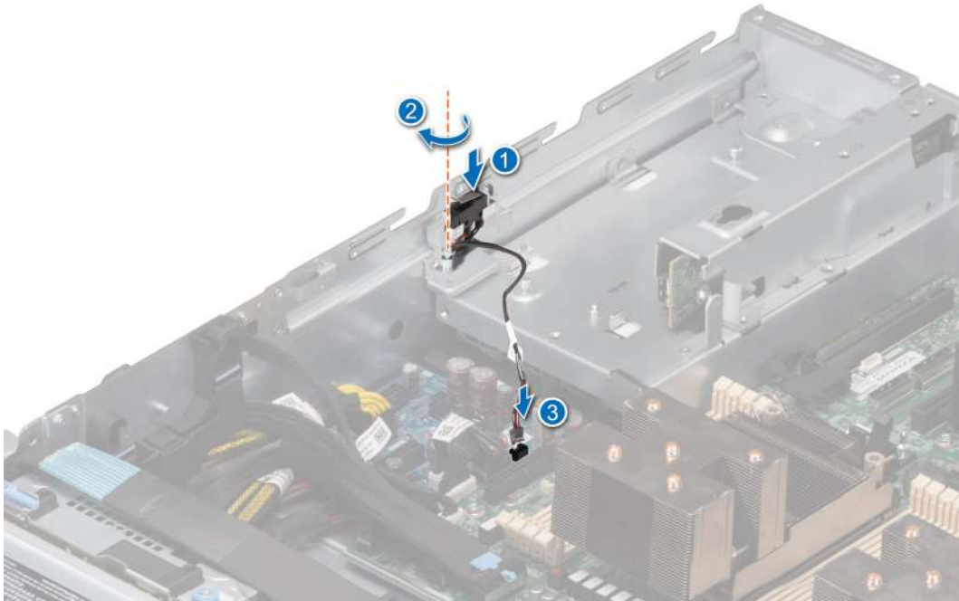
Ilustración 36. Instalación del interruptor de intrusiones
