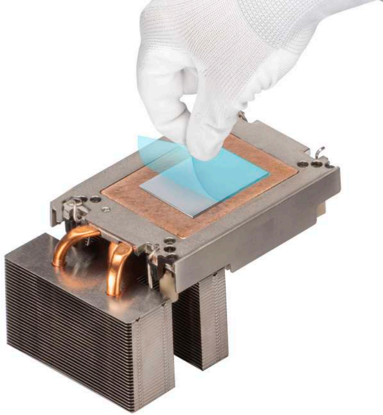
Ilustración 73. Extraiga la película de protección del material de interfaz térmica (TIM)
