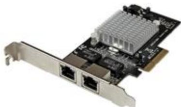
La carte réseau Gigabit PCI Express 2 ports ST2000SPEXI vous permet d'ajouter deux ports Gigabit Ethernet à un ordinateur de bureau via un slot PCI Express 4 voies (x4 ou plus). Chaque port est entièrement compatible avec les normes IEEE 802.3/u/ab, pour l'auto-négociation 10/100/1000 Mb/s.
