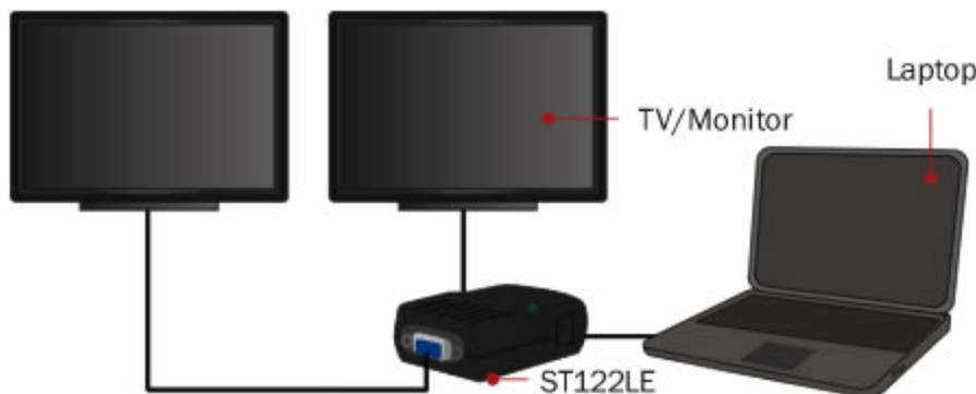
Le répartiteur VGA ST122LE prend en charge une installation facile et prête-à-l'emploi ; il bénéficie d'une garantie StarTech.com de 2-ans et d'une assistance technique gratuite à vie.
