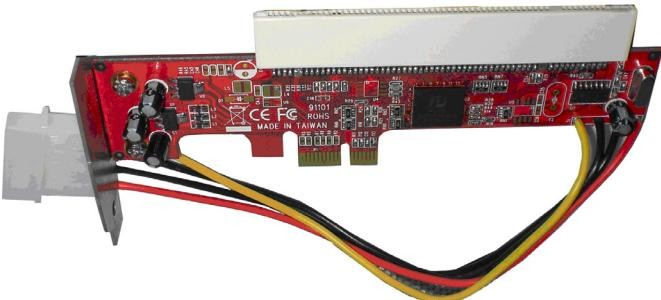
**Note:** Si le support de rechange PCIe est utilisé, le support sur la carte PCI doit être retiré sinon la carte PCI pourrait ne pas convenir à l'ordinateur.
