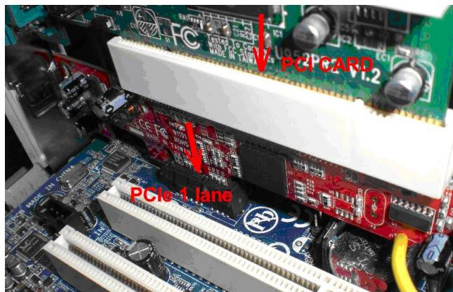
**Note:** Les logements PCIe sont compatibles à l'envers avec les cartes PCIe plus petites, donc un logement x4 ou plus peut être utilisé.
