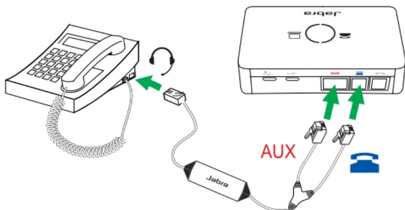
Eine spezielle Anleitung für die Verbindung des Electronic Hook Switch\* zum Tischtelefon finden Sie in der Dokumentation, die dem Adapter beiliegt.
