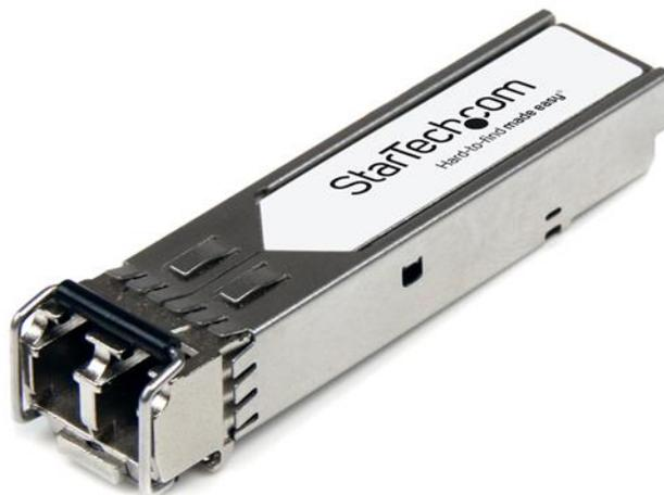
Der 455886-B21-ST ist ein HP 455886-B21-kompatibles Glasfaser SFP+-Transceiver-Modul, das für den Einsatz mit HP® Marken-Switches und -Routern entwickelt, programmiert und getestet wurde. Es sorgt für zuverlässige 10 GbE-Konnektivität über Glasfaser-Kabel für 10GBase-LR-konforme Netzwerke mit einer maximalen Entfernung von bis zu 10 km.
