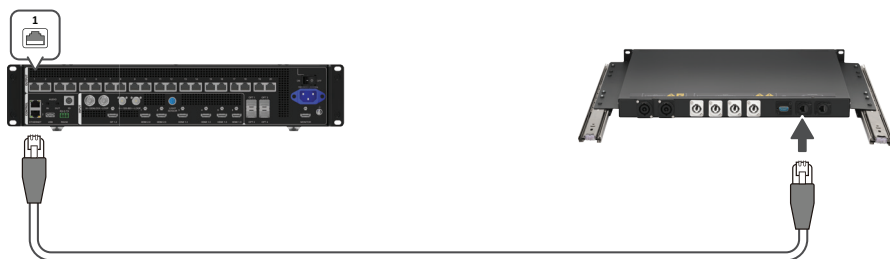
Netzwerkverbindung zwischen Strommodul und Steuergerät LD-SCB-024 (VX2000 Pro)
