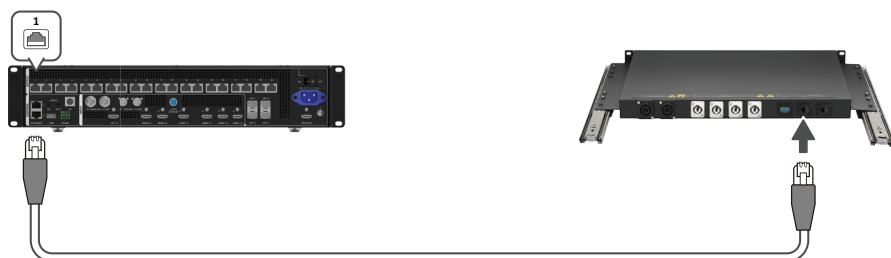
Conexión de red entre el módulo de alimentación y el control box LD-SCB-024 (VX2000 Pro)
