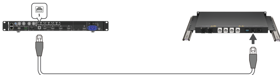
Connexion réseau entre le module d'alimentation et le boîtier de contrôle LD-SCB-025 (VX600 Pro)
