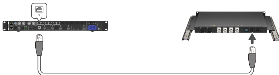
Netzwerkverbindung zwischen Strommodul und Steuergerät LD-SCB-025 (VX600 Pro)
