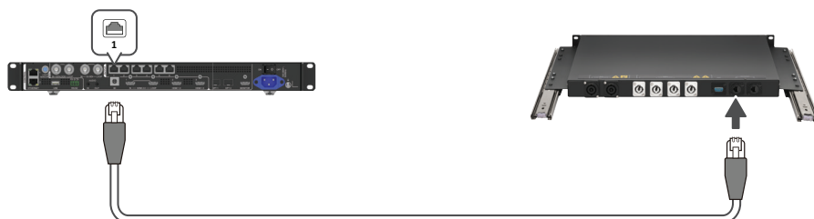
Conexión de red entre el módulo de alimentación y el control box LD-SCB-025 (VX600 Pro)
