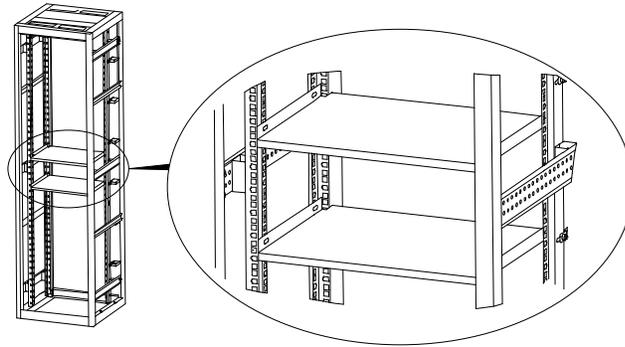
아래 그림을 참조하여 UPS 와 배터리 팩을 19" 랙 인클로저에 설치하십시오.
