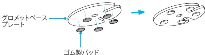
4. グロメットベースプレートの突起が支柱の2つの穴のうち1つにフィットするように、取付表面のグロメット穴の上にグロメットベースプレートを、グロメットベースプレートの上に支柱(2)を配置します。(図7)
