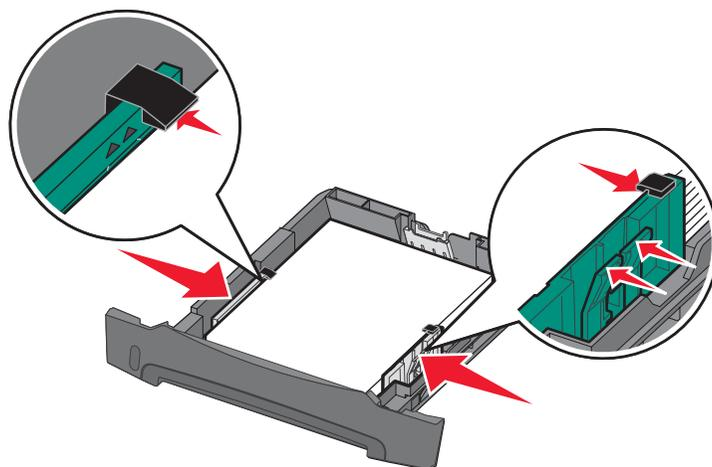
**Nota:** para la impresión simplex, cargue el papel con cabecera con la cara del diseño hacia abajo. El borde superior de la hoja con el logotipo se debe colocar en la parte frontal de la bandeja. Para la impresión dúplex, cargue el papel con cabecera con la cara del diseño hacia arriba.
