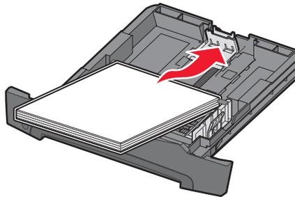
**Nota:** asegúrese de que la pila de papel está colocada en horizontal y no excede los indicadores de relleno máximos. Una carga incorrecta puede provocar atascos.
