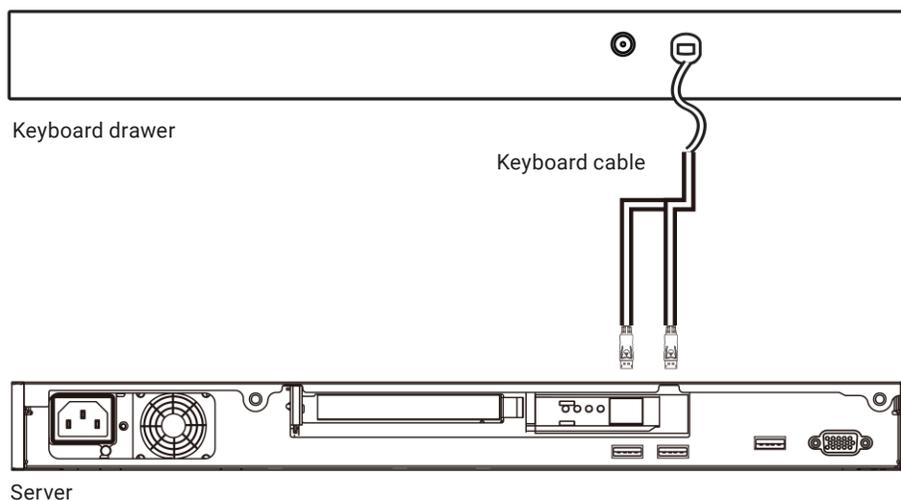
FIGURE 4. CONNECTING TO THE SERVER
