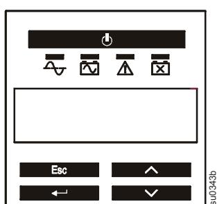
Si la pantalla Battery Install Date (Fecha de instalación de la batería) no aparece en la interfaz de pantalla después de dos minutos de haber instalado la batería nueva, use las teclas de flecha para desplazarse por: **Menú principal > Configuración > Fecha de instalación de la batería**.
