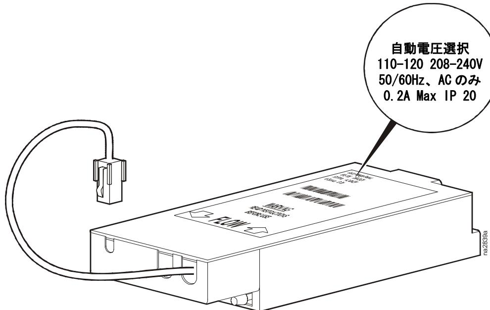
自動電圧選択ドレンポンプの定格入力電源は 120/240V、50/60 Hz であり、InRow® SC 冷却ユニット、InRow RC 冷却ユニット、NetworkAIR® ACPA4000 で使用される 120V 及び 220V のドレンポンプと交換可能です。電圧に関する情報はドレンポンプ前面のラベルに記載されています。
