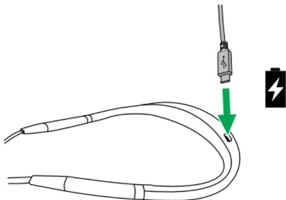
Remarque : Le port de charge USB doit toujours être nettoyé et séché avant de charger le casque. Il est recommandé de charger l'oreillette au moins une fois par mois.
