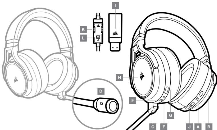
**A** — Селекторный переключатель режима беспроводной/проводной связи
