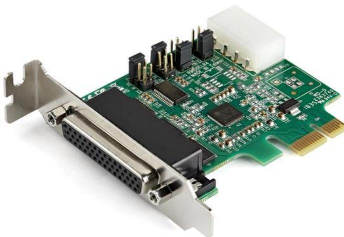
Cette carte série PCI Express RS232 vous permet d'ajouter quatre ports série RS232 (DB9) à votre ordinateur via un slot PCI Express (PCIe). La carte série PCIe 4 ports vous permet d'interagir avec des appareils série tels que des lecteurs de cartes, des imprimantes, des claviers NIP et des modems, à des vitesses pouvant atteindre 921,6 Kbit/s.
