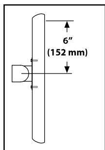
Bij de bevestigingshoogte wordt aangenomen dat er 152 mm ruimte is tussen het midden van de gaten voor het bevestigen van uw monitor en de bovenkant van het scherm. Als uw ruimte kleiner is, moet u de opstellingshoogte overeenkomstig vergroten, als uw ruimte groter is, moet u uw opstellingshoogte overeenkomstig verkleinen.
