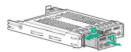
To remove the drive carrier:
