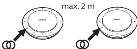
Um die Freisprecheinrichtungen zu trennen, drücken Sie die **Link**-Taste an einem der Freisprechgeräte.
