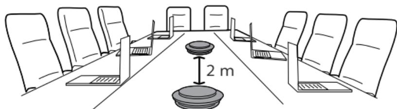
Um eine vorübergehende Verbindung der beiden Jabra Speak 710 herzustellen, drücken Sie die **Link**-Tasten zur Kopplung der beiden Freisprecheinrichtungen bei einem maximalen Geräteabstand von 2 m.
