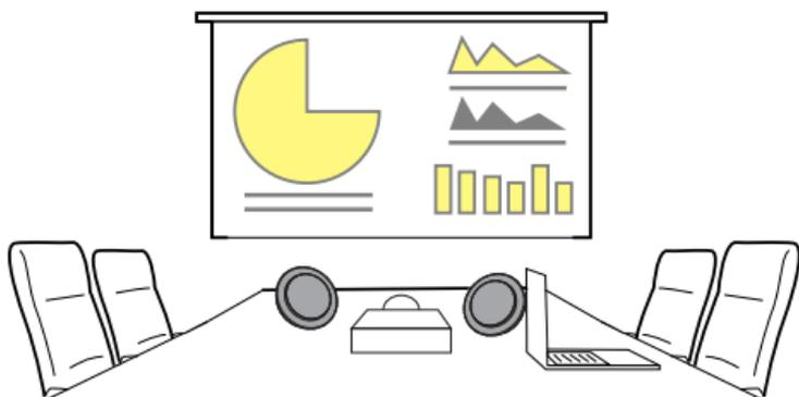
Um eine vorübergehende Verbindung der beiden Jabra Speak 710 herzustellen, drücken Sie die **Link**-Tasten zur Kopplung der beiden Freisprecheinrichtungen bei einem maximalen Geräteabstand von 2 m.
