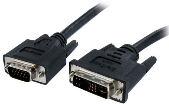
Das DVI-auf-VGA-Display-Monitorkabel DVIVGAMM2M (2m) ist mit einem DVI-A-Stecker und einem VGA-Stecker ausgestattet, sodass Sie ein VGA-Display an einen PC oder Mac® mit DVI-I-Analogausgang anschließen können.
