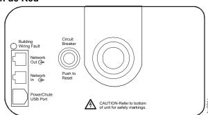
Su Back-UPS protege el equipo conectado a una red Ethernet 10/100 Base-T contra subidas de tensión cuando este se conecta a través de las tomas Ethernet de dicho
