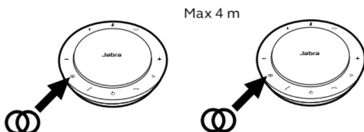
Um die Freisprecheinrichtungen zu trennen, tippen Sie auf die **Link**-Taste an einem der Freisprechgeräte.
