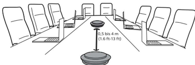
Um eine vorübergehende Verbindung der beiden Jabra Speak 750-Geräte herzustellen, tippen Sie auf die **Link**-Tasten an beiden Freisprecheinrichtungen (maximaler Geräteabstand 4 m).
