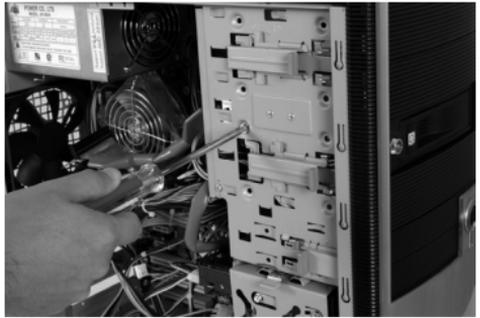
5. Connectez les câbles d'alimentation et de données SATA dans les ports appropriés sur le panneau arrière du cadre de disque.
