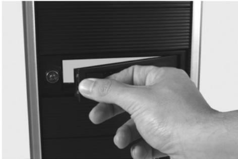
2. Placez le disque dur à proximité de l'entrée du cadre, avec l'étiquette du disque dur tournée vers le haut et le panneau arrière du disque dur dirigé vers l'intérieur de l'ordinateur.
