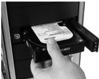
4. Sécurisez le disque dur dans le cadre en fermant le bras de verrouillage. Appuyez doucement sur le bras de verrouillage, jusqu'à ce que vous entendez le « clic » de la serrure à ressort.
