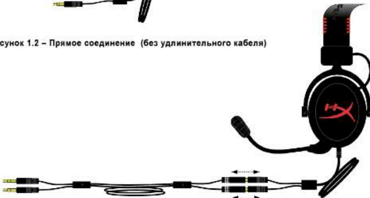
Рисунок 1.3 – Прямое соединение (с двухметровым удлинительным кабелем)
