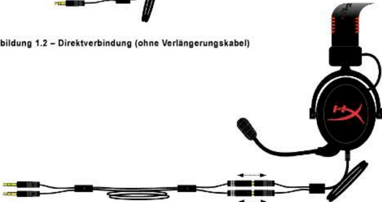
Abbildung 1.3 – Direktverbindung (mit 2-m-Verlängerungskabel)
